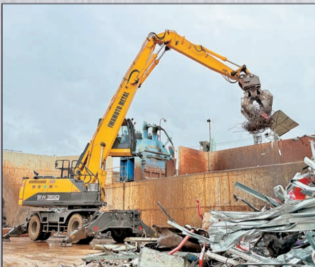
SW350-7：大阪工場稼働するSW350-7はホイール式のマテリアルハンドリング機だ。ホイール走行の円滑な移動で油圧シャーへの母材投入など工場内の荷捌きを行っている。
